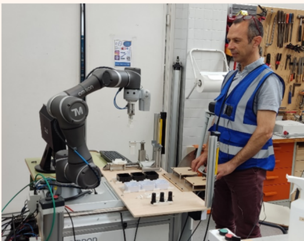
Célula con robótica colaborativa para personas con discapacidad visual .
